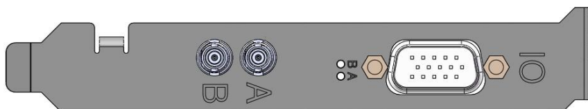
图 44 Vulcan-CXP12-2 采集卡前面板结构示意图
