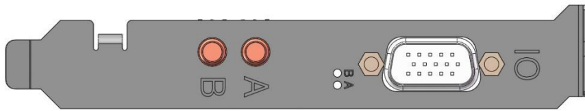
图 40 Vulcan-CXP6-2 采集卡前面板结构示意图
